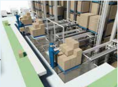
常温自動倉庫 (2F) ピッキング間口
